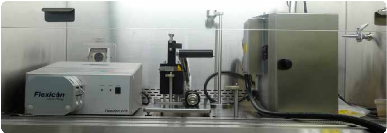
La filling station permet de remplir à la chaîne des flacons avec des cellules
